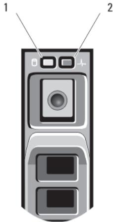
Abbildung 3. Festplatten-/SSD-Laufwerksanzeigen
